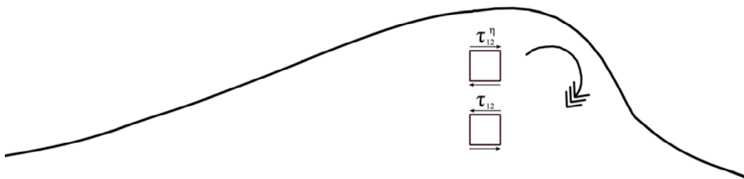
Σχήμα 6: Διατμητικές τάσεις στην θραυόμενη κορυφή και δημιουργία του στροβίλου θραύσης.
